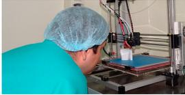
Se trata de una impresora 3D que a partir de una tomografía (imagen tridimensional) de la zona afectada del paciente, permite a través de un software de reconstrucción, producir moldes anatómicos de huesos y tejidos.
